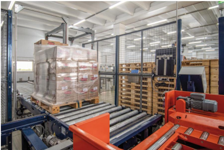
sur place, une navette motorisée pénètre à l'intérieur des rayonnages pour introduire les palettes à l'emplacement libre le plus profond du canal.
