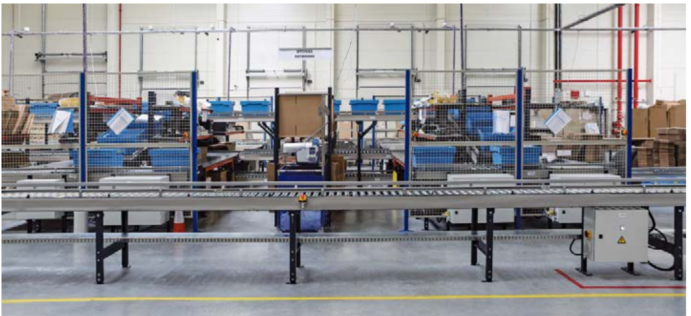
Les caisses arrivent aux postes de picking à travers un circuit de convoyeurs mesurant 38,2 m de long
